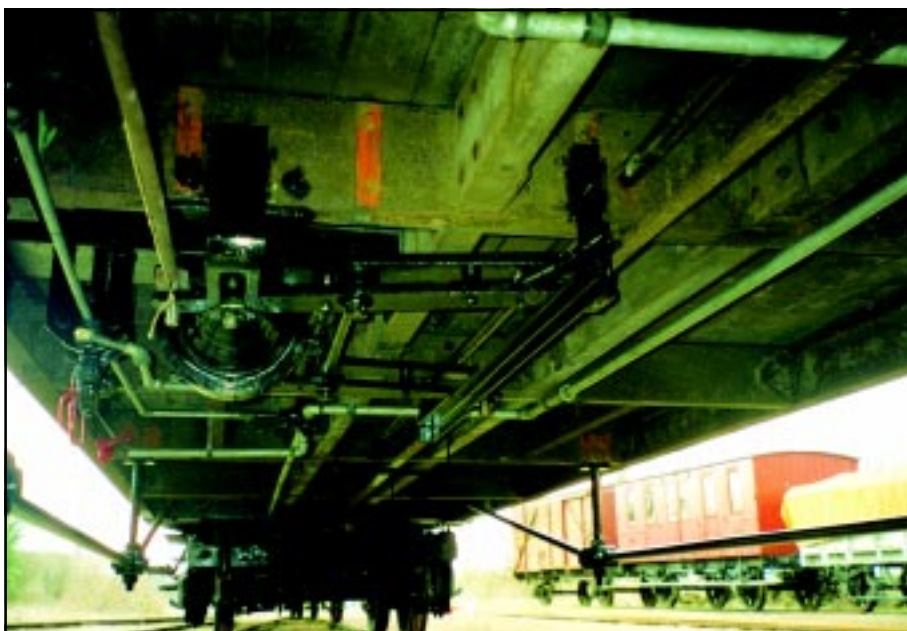
Det nye bremsesystem monteret på Bc 18's undervogn.
