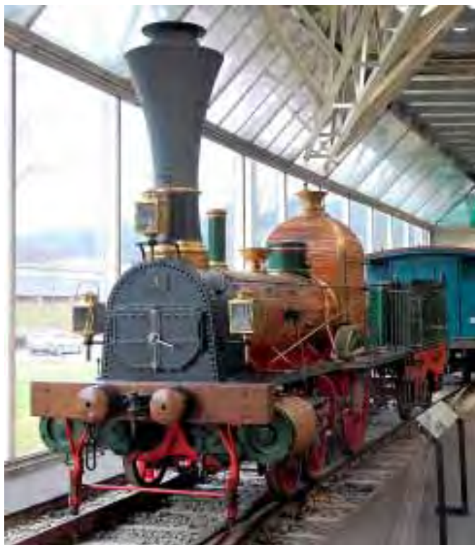
IL 4-83 Replika af det 2'A koblede lokomotiv Limmat. Originalen og et til af samme type blev leveret af Kessler i Karlsruhe til åbningen af Schweiz første jernbane, Zürich-Baden, i 1847. Tidligere udstillet på Verkehrshaus der Schweiz i Luzern. Foto PT 2009.
