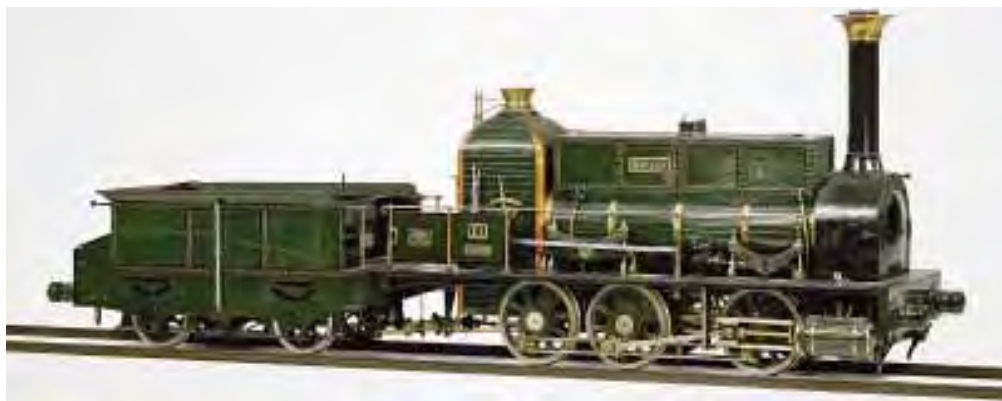
IL 4-75 1847-50 leverede Maffai fem stk. trekoblede lokomotiver til Bayeriske Statsbaner. Vandkassen oven på lokomotivet havde til formål at hæve akseltrykket, så det bedre kunne stå fast. Model i Deutsches Museum, München. Foto Deutsches Museum.
