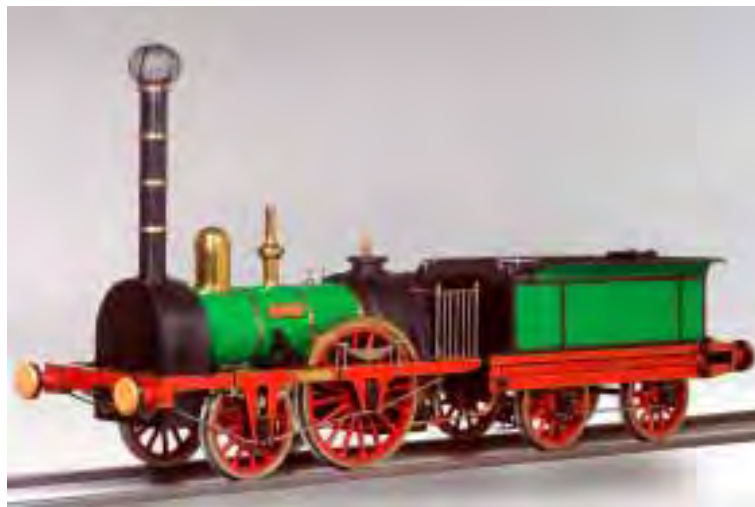
IL 4-77 Til åbningen af Kaiser Ferdinands Nordbahn fra Wien til Breclav indkøbtes bl.a. lokomotivet "Austria" fra Robert Stephenson & Co – et lokomotiv af Stephenson's Planet-type, som denne havde set ud siden 1831/32. Model i 1:5. Inv. Nr. 40.365 Technisches Museum Wien. Foto Technisches Museum Wien.
