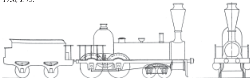
IL 4-84 Den anden lokomotivtype, der leveredes af Kessler til åbningen af banen Zürich-Baden i 1847, var to eksemplarer af en også Norris-præget 2'B type. Gengivet fra Moser: Der dampbetrieb der Schweizerischen Eisenbahnen, 1938, s. 73.
