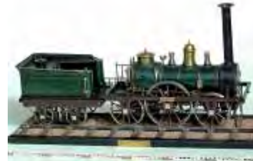
IL 4-78 lokomotivet "Vindobona" fra Robert Stephenson & Co i 1837 var det første af en hel række 1A1 Patentee-lokomotiver leveret af forskellige producenter til Kaiser Ferdinands Nordbahn før 1840. Model tilhørende Technisches Museum Wien. Inv. Nr. 40.005. Foto Technisches Museum Wien.
