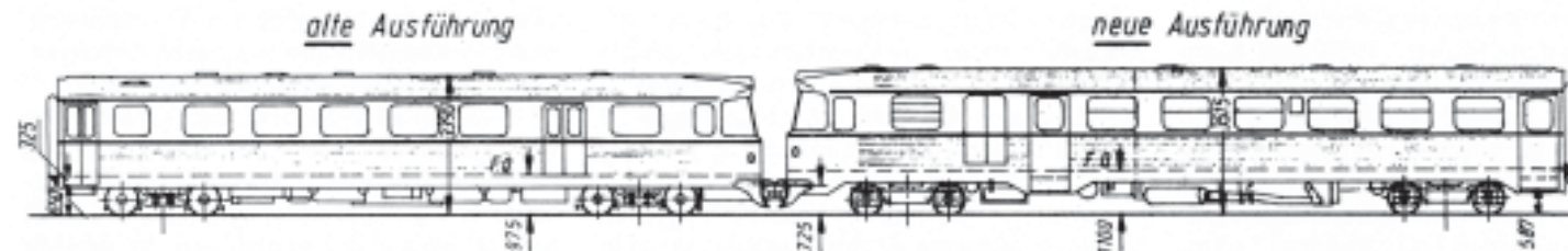
Skitse fra 1977, der viser dimensionsforskellene mellem det almindelige Y-tog (t.v.) og den projekterede, kraftigere type. (Duewag)
