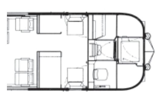
BS-vognens førerrum var hævet over vognulvet, og dets gulv kunne skydes i vejret. (MAN/bb)
