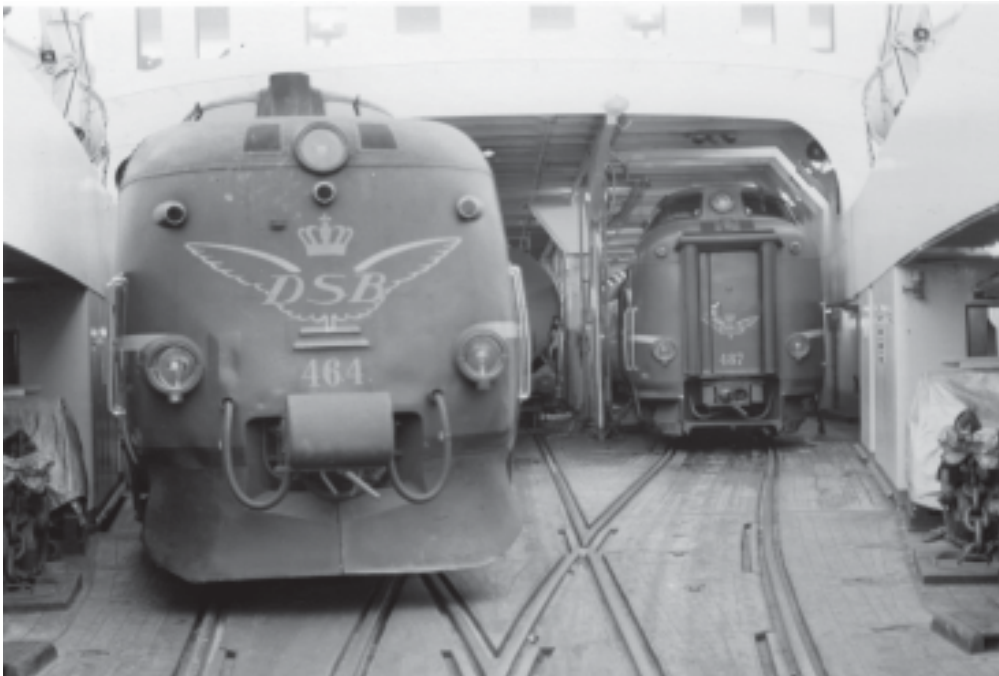
Scharfenberg-koblingen sad på mellem- og styrevognene a.h.t. overgangen relativt lavt, men på MA-motorvognens front sad den højere. MA 464 og BS 487 på Storebæltsfærgen „Fyn“ 1968. (JSt)
