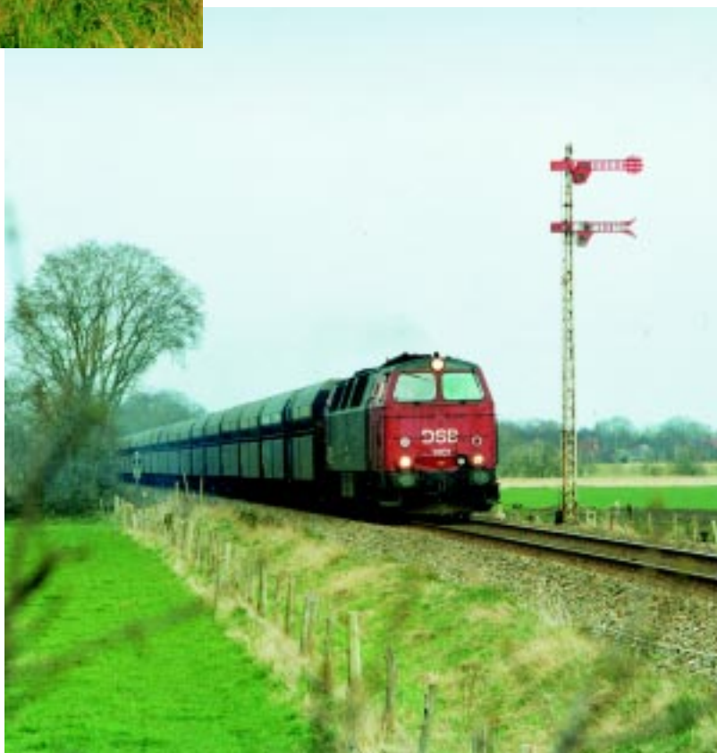
MZ 1401 buldrer ud af Borris mod vest med tomme kulvogne fra Herningværket den 3. april 2000. Ved denne lejlighed var stationen betjent på grund af krydsning med Lemvigbanens godstog. Derfor står indkørselssignalet på stop.
